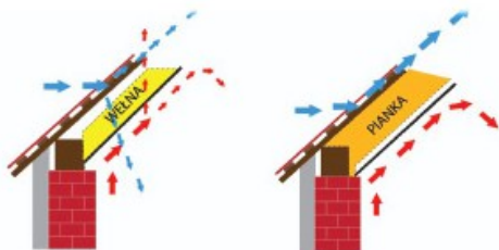
Porównanie ruchu powietrza przy użyciu tradycyjnego „przewodnego” materiału i Skutecznego Ocieplania pianką
